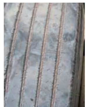
เมื่อไม่มีระบบ ABS (4 เดือนหลังจากการใช้งาน)
