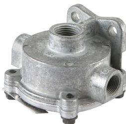
15-2280 วาล์วระบายลม SEALCO 2000D½ ทางเข้า 1/2" NPT ทางออก 3/8" NPTx2
