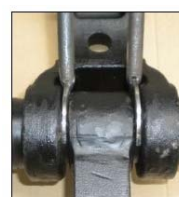
รูปตัวอย่างเครื่องมือพิเศษ เพื่อป้องกันแขนยึดถูกดึงไปด้านใดด้านหนึ่ง และบูชปริ้น
